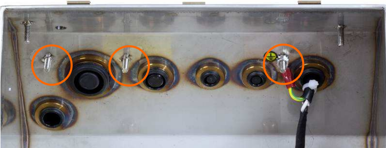
图 2-12: 仪表内部的接地螺柱
