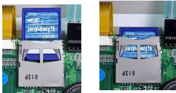
图 2-48: 将 SD 卡插入 SD 卡槽 (左); SD 卡安装完成 (右)
