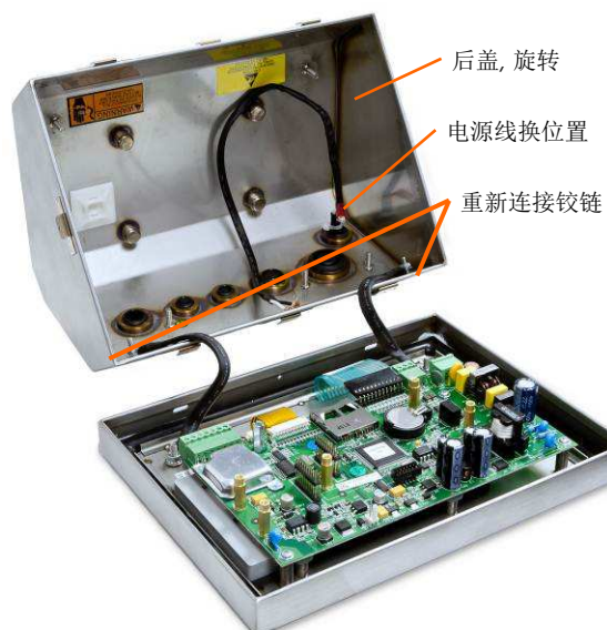
图 2-5: 后盖反转后视图
