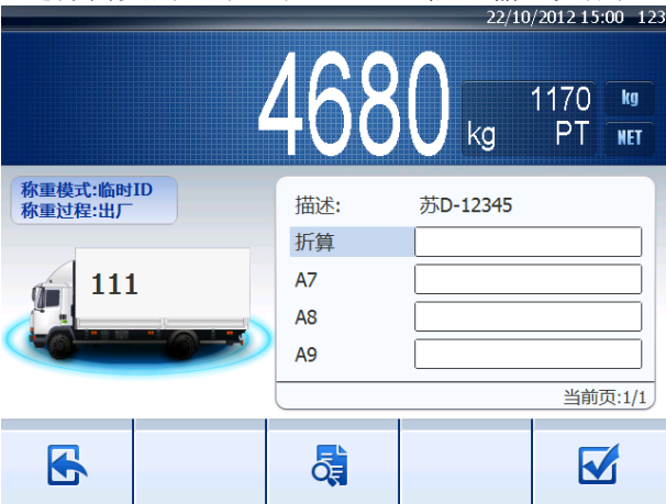
图 2-17：临时 ID – 出厂过程,A6~A9 输入
