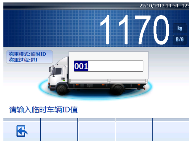
图 2-13: 临时 ID – 临时 ID 记录输入
